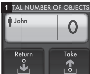
1 Sätt in din användartagg. Systemet visar antal verktyg som du innehar.
